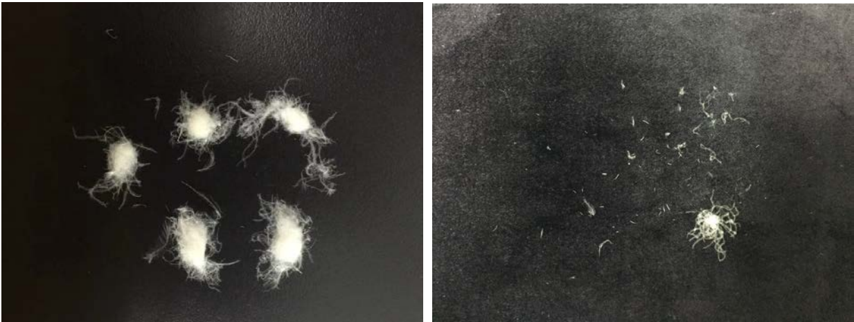
图A.1 “蚕茧式”羽绒拆开前照片（左）和“蚕茧式”羽绒拆开后的照片（右）
